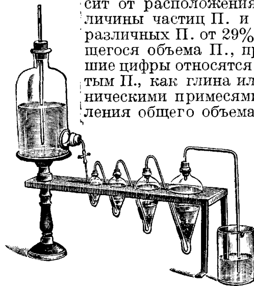
Рис. 2. Прибор Небеля для отмучивания почвы.
